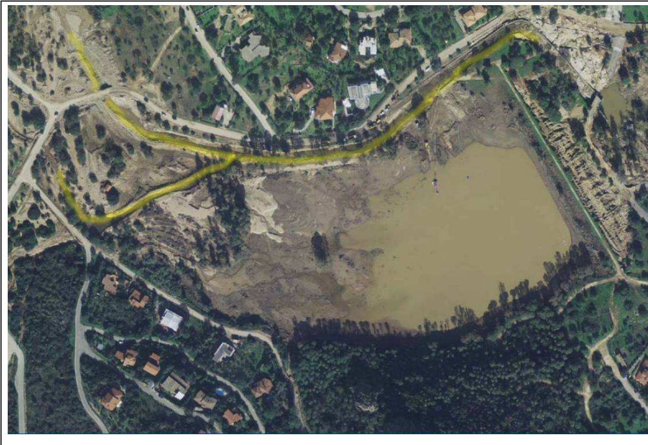
Figura 72 - Canale diversivo e completamento dell'abbassamento del livello del lago q.ta 59. (Foto aerea 6.11.08)
